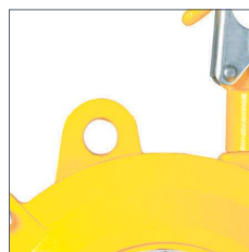
Anillas de suspensión Según la norma DIN 15112, los equilibradores deben estar equipados con anillas de suspensión adicionales para la conexión de cadenas de seguridad secundarias.
