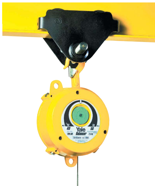
Anillas de suspensión Según la norma DIN 15112, los equilibradores deben estar equipados con anillas de suspensión adicionales para la conexión de cadenas de seguridad secundarias.
