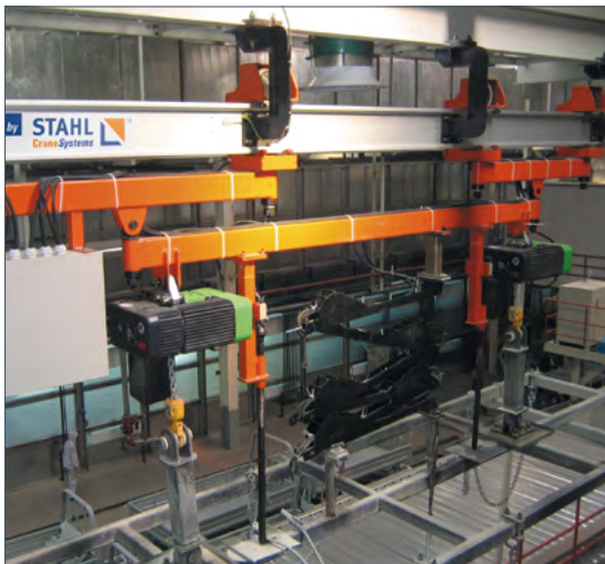
Dans une usine de revêtement pour l'industrie automobile en Chine, 48 palans à chaîne ST spécialement conçus fonctionnent à des niveaux d'humidité très élevés.
