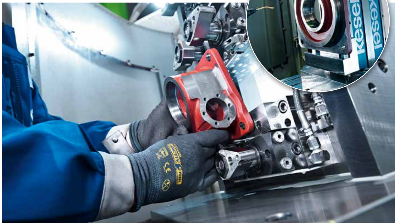
Production Pfaff-silberblau : Usinage de boîtiers vérins à vis sans fin
