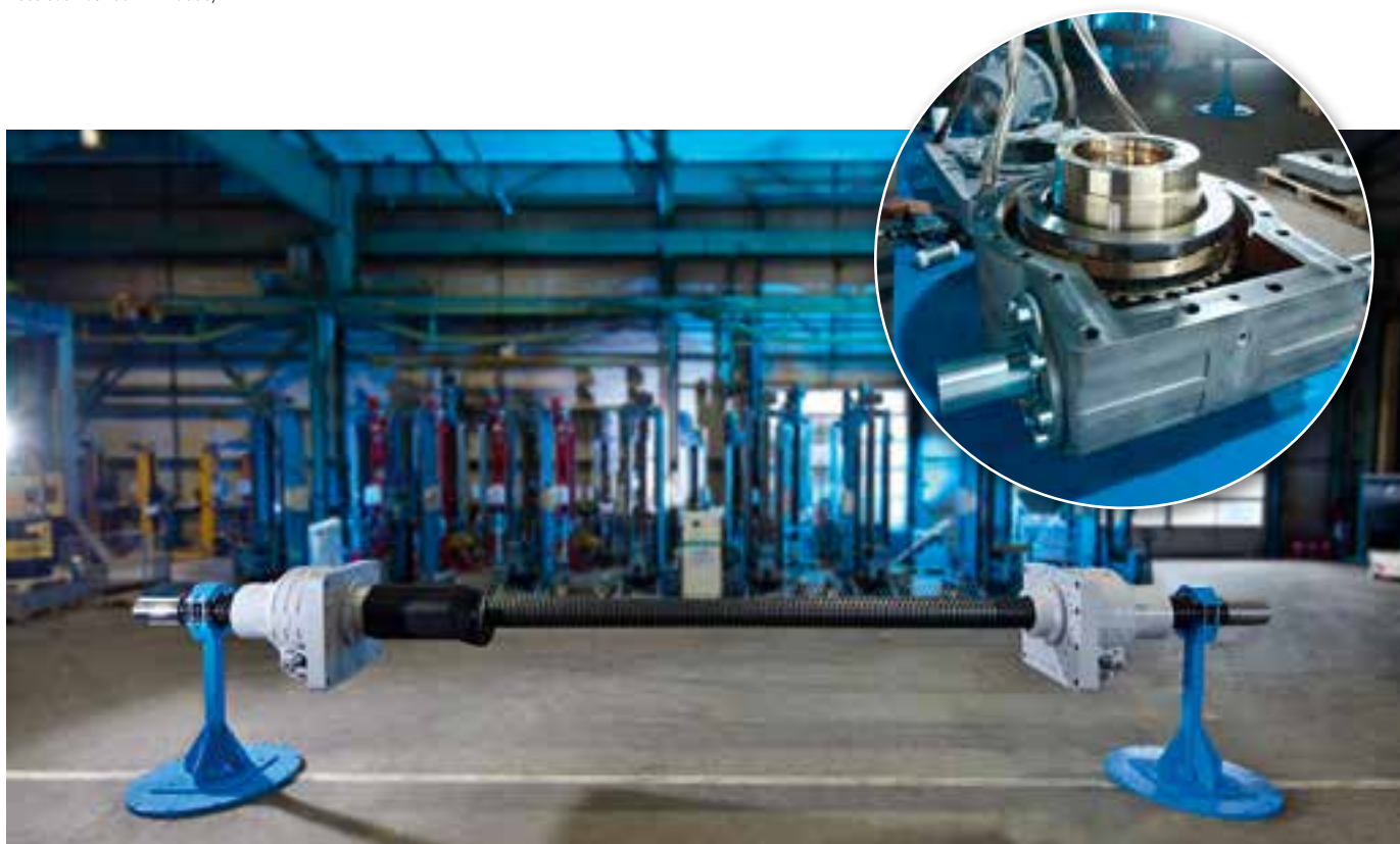
Montage Pfaff-silberblau: Sonderausführung Spindelhubelement SHE 200.1 mit 8 Meter langer Spindel und Faltenbalg. Auslegung für eine statische Belastung von 400 Tonnen.
