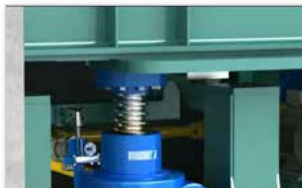
Pfaff-silberblau – 500-Tonnen-Hubanlage zur Verstellung von Zinköfen
