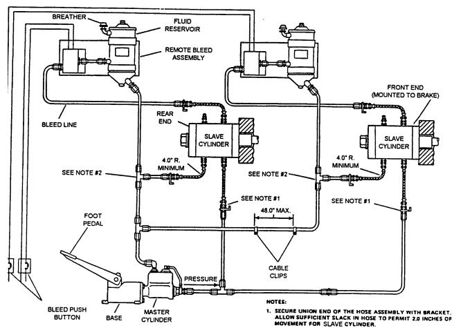
2. THE UNION TEE MUST BE MOUNTED SO THAT THE HYDRAULIC LINE CONNECTING THE SLAVE CYLINDER AND THE DIL RESERVOIR IS AT ITS SHORTEST PRACTICAL LENGTH.
