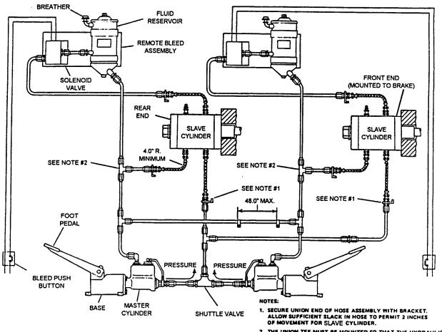
2. THE UNION TEE MUST BE MOUNTED SO THAT THE HYDRAULIC LINE CONNECTING THE SLAVE CYLINDER AND THE OIL RESERVOIR IS AT ITS SHORTEST PRACTICAL LENGTH.
